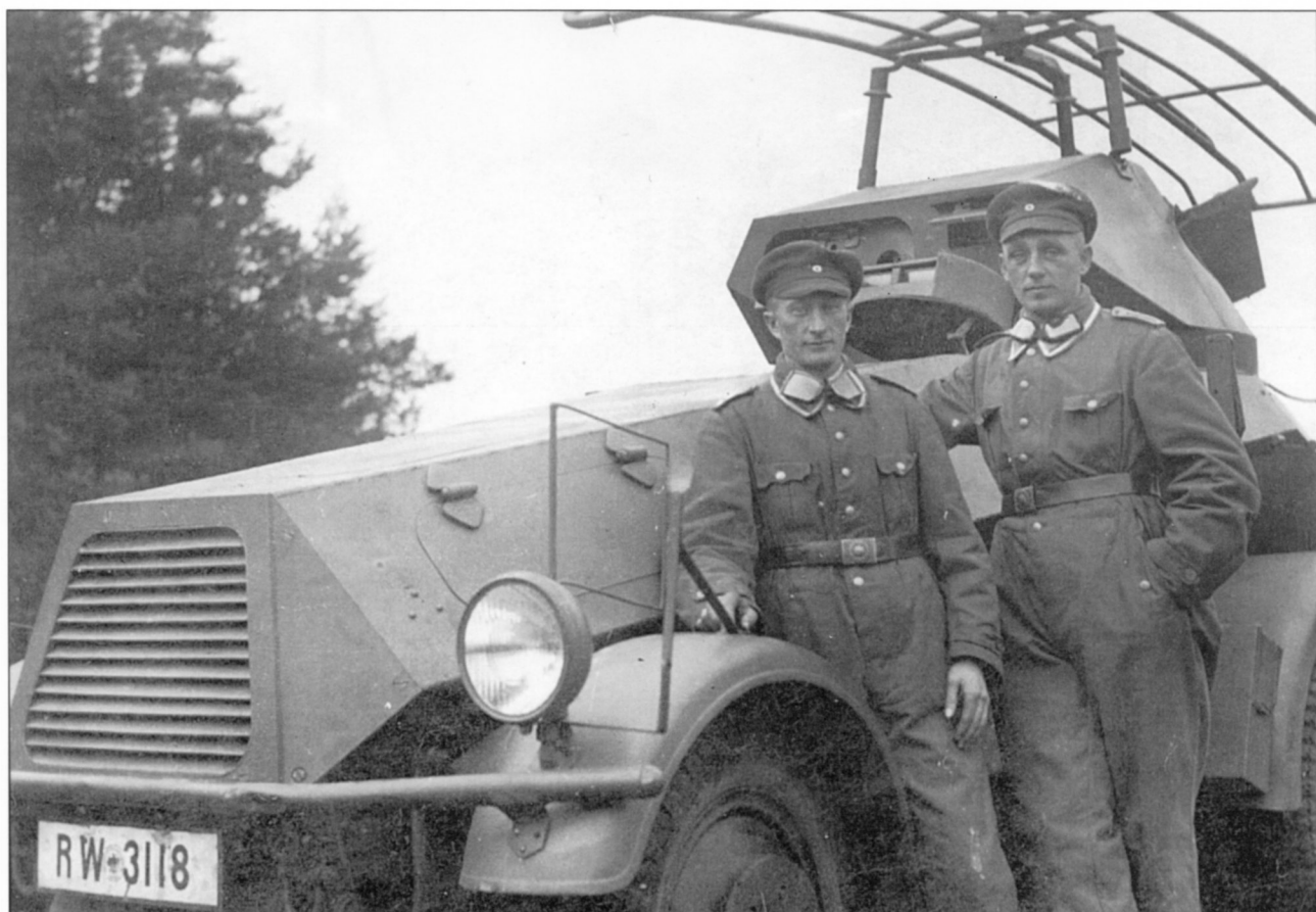
Бронеавтомобиль Sd.Kfz.232(6-Rad), а точнее — еще Kfz.67a, так как на машине регистрационный номер Рейхсвера. Судя по жалюзи радиатора, это машина фирмы Krupp
