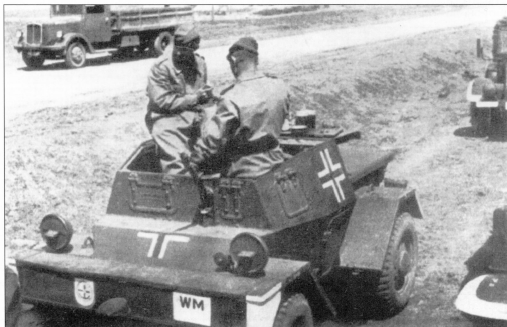
Бронев автомобиль Pz. Spah. 204(f). Франция, 1943 год. Вместо 25-мм пушки на этой машине установлен второй пулемет
