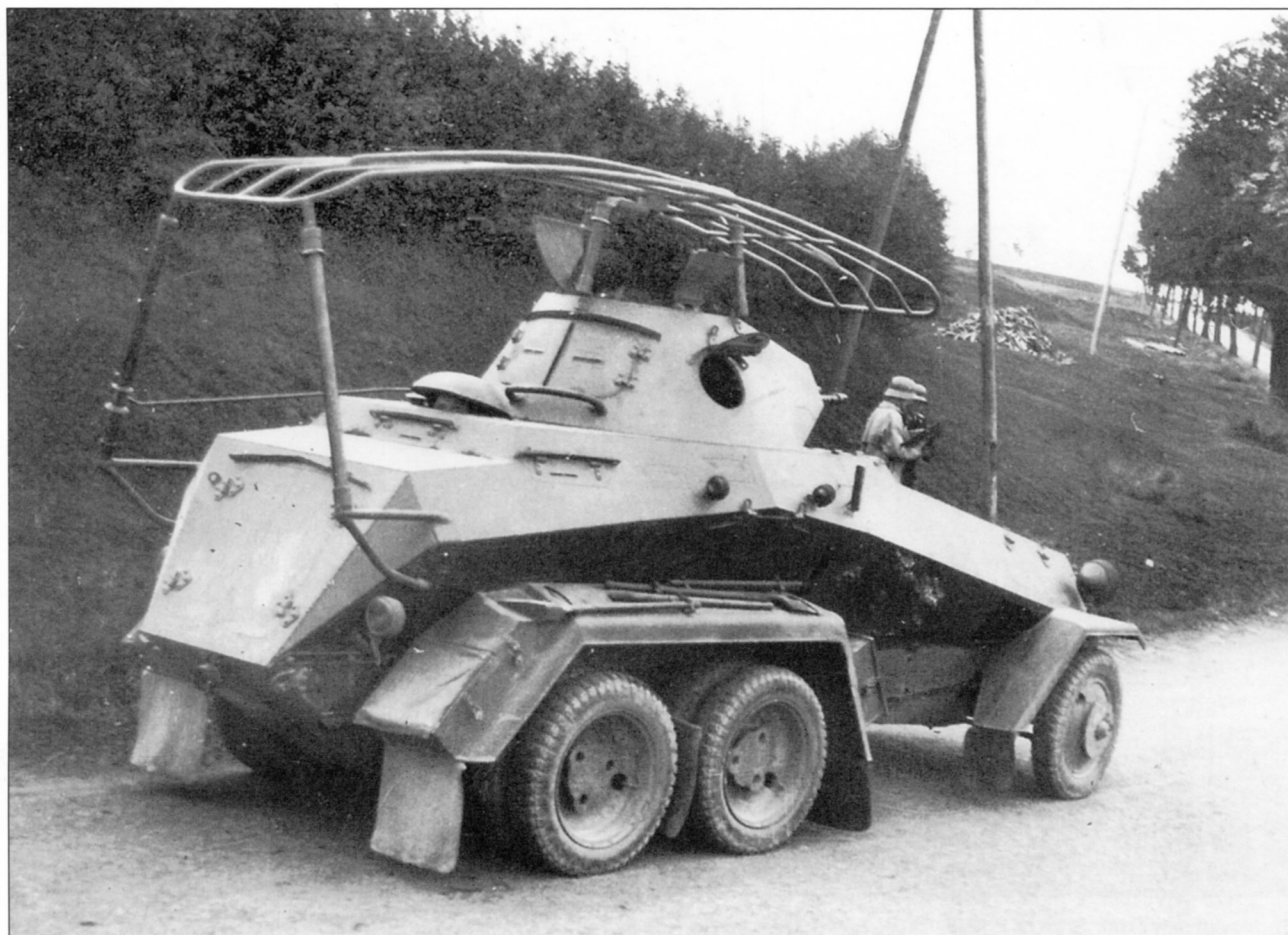
Бронеавтомобиль Sd.Kfz.232(6-Rad). Хорошо видны все узлы крепления антенны
