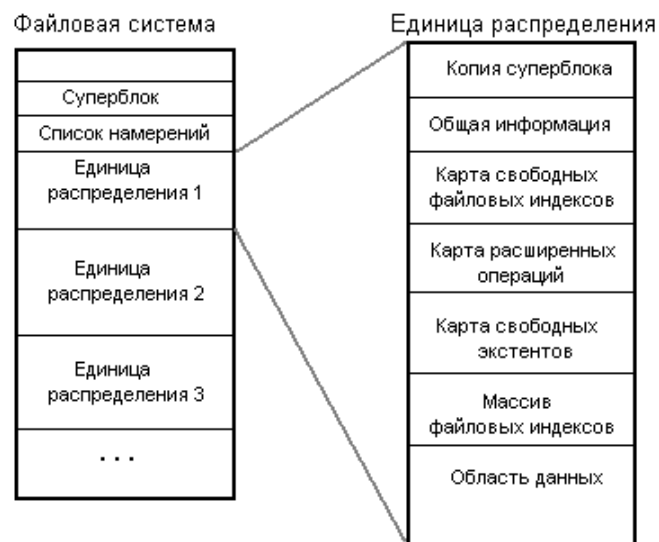
Рисунок 6.7 Структура файловой системы vxfs v.1
