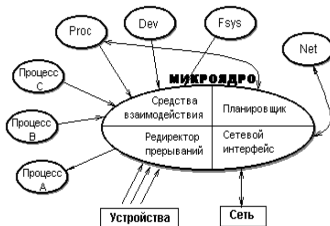
Рисунок 10.1 Архитектура ОС QNX.
