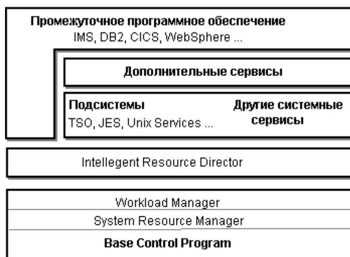
Рисунок 12.5 Структура программного обеспечения z/OS
