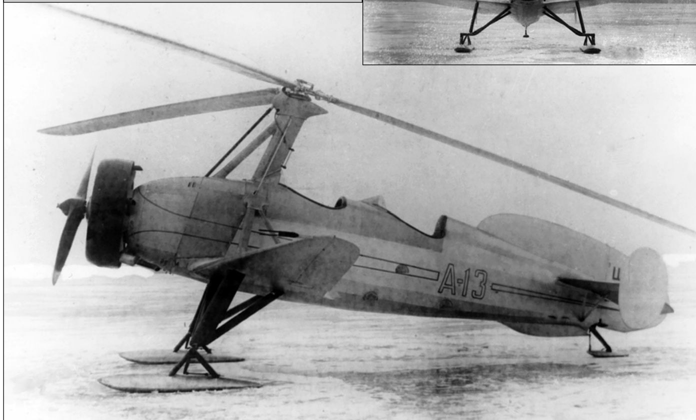
Виды автожира А-13 в процессе испытаний на лыжном шасси в марте 1936 г.
