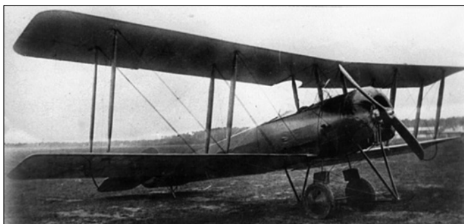
При создании первого советского автожира КАСКР использовался фюзеляж, шасси, силовая установка и хвостовое оперение учебного самолета Авро 504К. В СССР этот самолет под обозначением У-1 (Учебный – первый) строился серийно на авиационном заводе №23 (ГАЗ №3) в Ленинграде
