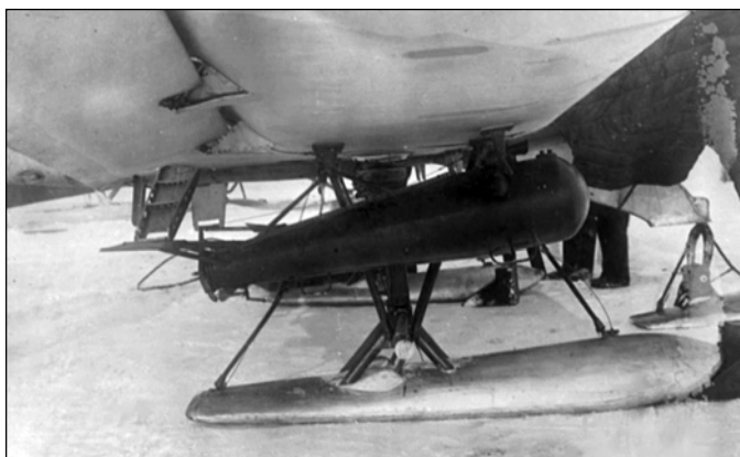
Подвеска под крылом выливных авиационных приборов (ВАП)
