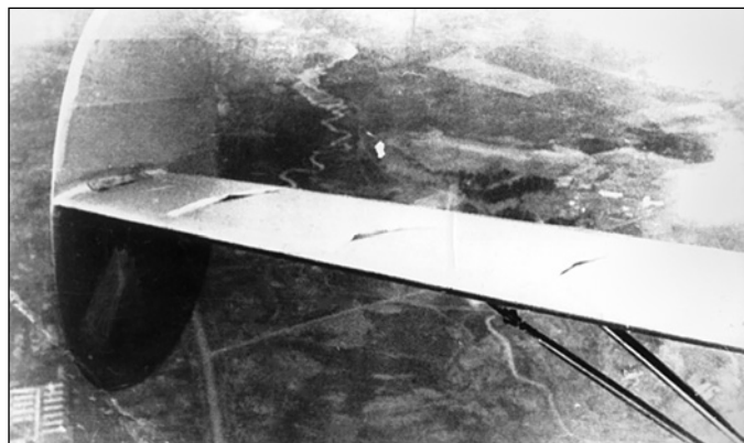
Полетный снимок стабилизатора А-13 с наклеенными полотняными ленточками для определения равномерности обтекания. Судя по тому, что ленточки прижаты к поверхности стабилизатора, обтекание в норме
