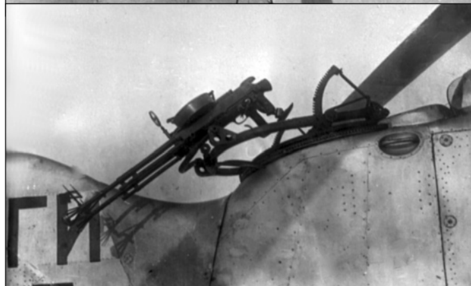
Спарка пулеметов ДА на турели ТУР-5 при различных вариантах обстрела
