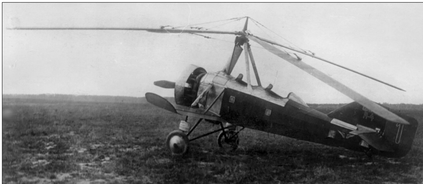
Первый серийный А-4, заводской №4301, в процессе государственных испытаний осенью 1933 г. На вертикальном оперении заметна небольшая надпись «ЦАГИ А-4» и бортовая цифра «1» наиболее вероятно красного цвета в белой окантовке. Испытания проходили в подмосковном Щелково на аэродроме НИИ ВВС, строительство и оборудование которого продолжалось. На нижнем снимке видны конные повозки, на которых подвозят грунт для присыпки взлетно-посадочной полосы
