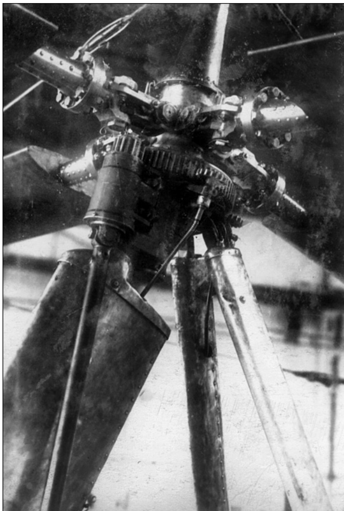
Головка ротора автожира А-4. Видны шестерни и вал привода механического запуска ротора
