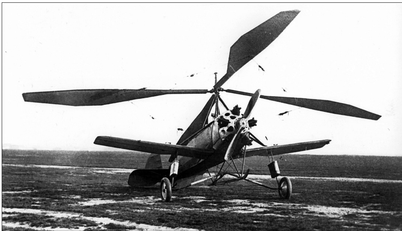
Автожир КАСКР-2 явился значительно переработанным образцом по сравнению с первоначальным экземпляром КАСКР-1
