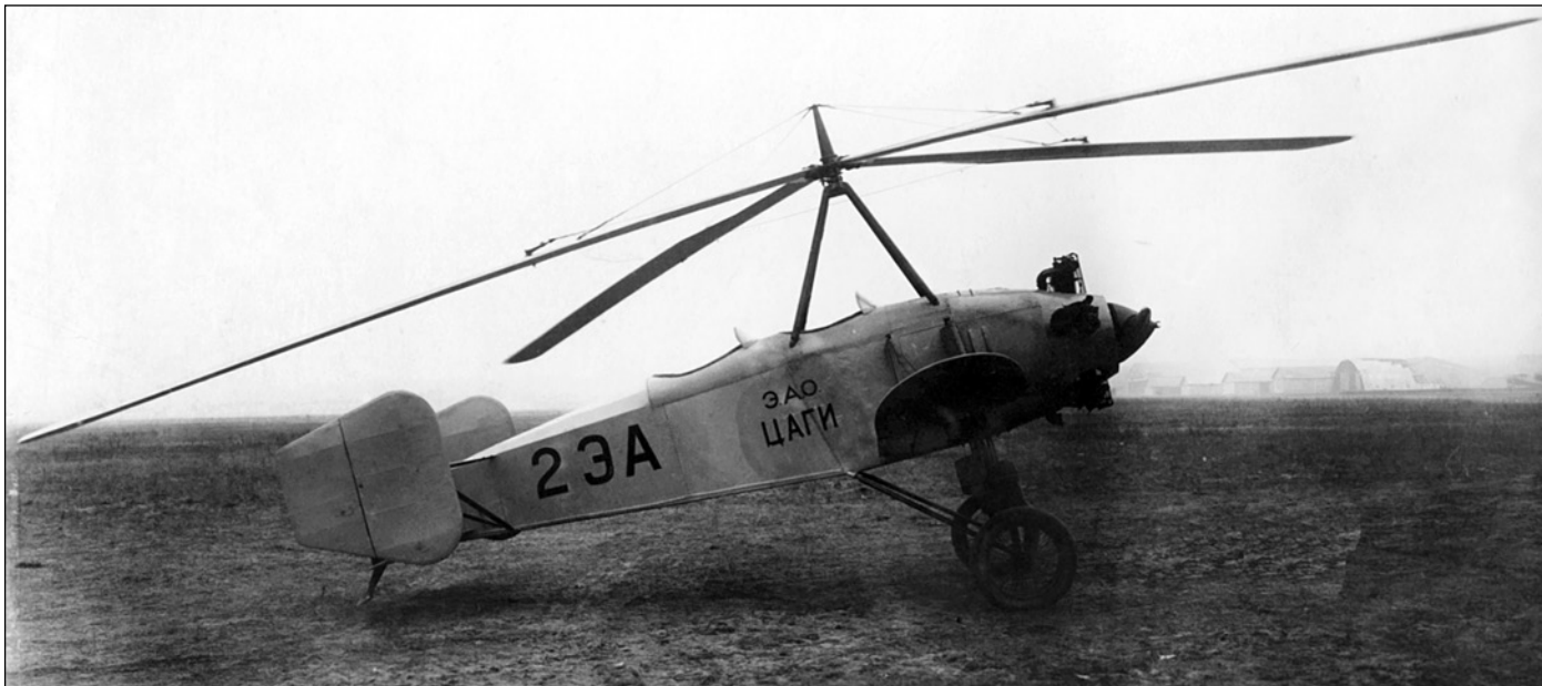
ЦАГИ 2-ЭА – первый экспериментальный автожир конструкции Центрального аэрогидродинамического института. Снимок сделан 21 ноября 1931 г. на Центральном аэродроме Москвы, через три дня после первого полета С.А. Корзинщикова
