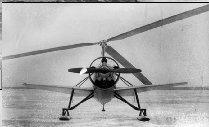
Виды автожира А-13 в процессе испытаний на лыжном шасси в марте 1936 г.
