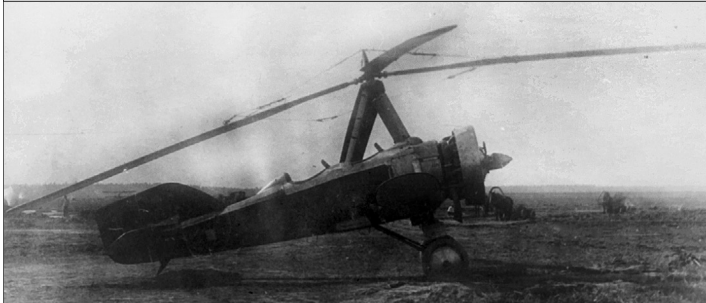
Первый серийный А-4, заводской №4301, в процессе государственных испытаний осенью 1933 г. На вертикальном оперении заметна небольшая надпись «ЦАГИ А-4» и бортовая цифра «1» наиболее вероятно красного цвета в белой окантовке. Испытания проходили в подмосковном Щелково на аэродроме НИИ ВВС, строительство и оборудование которого продолжалось. На нижнем снимке видны конные повозки, на которых подвозят грунт для присыпки взлетно-посадочной полосы
