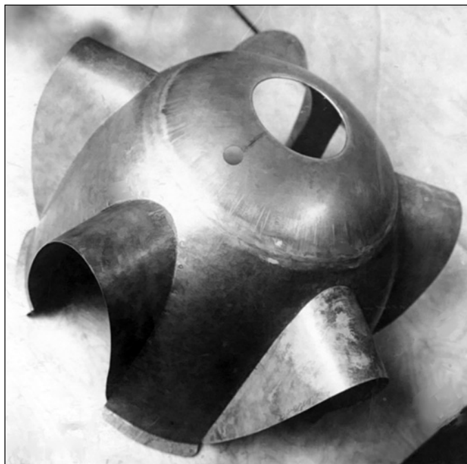
Капот картера двигателя М-11 автожира А-13
