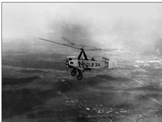
Автожир ЦАГИ 2-ЭА в полете над пригородами Москвы. Пилот управляет аппаратом из задней кабины. Фотоснимок выполнен в воздухе с летящего рядом самолета Р-5
