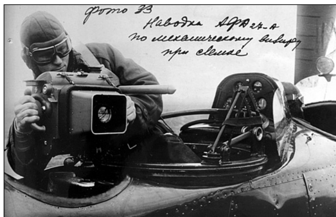
Установка на оборонительной турели автожира А-7 фотоаппарата для перспективной аэрофотосъемки АФА-27А
