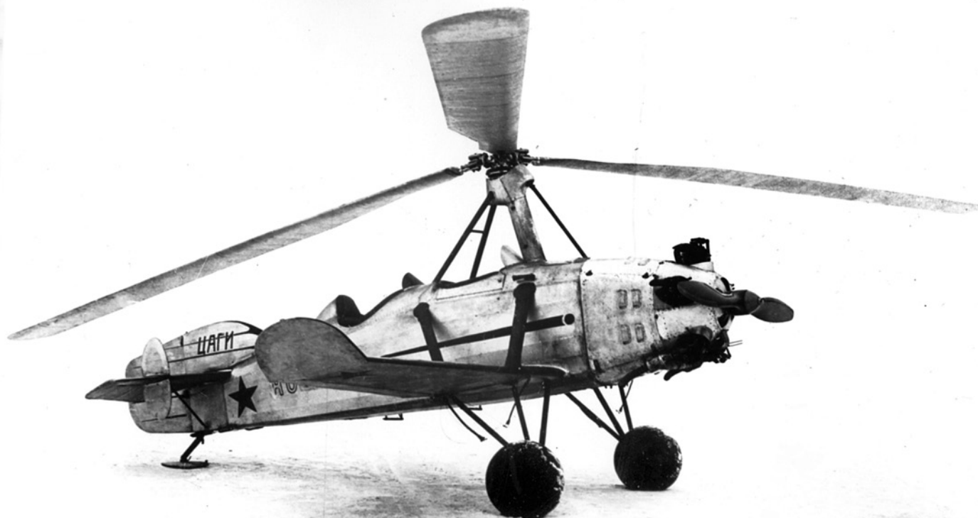
Автожир ЦАГИ А-6 в период подготовки к испытаниям в НИИ ВВС осенью 1933 г. Вертикальное оперение А-6 дополнено небольшими вертикальными киями. На хвостовом костыле установлена лыжа, основное шасси оборудовано баллонными колесами, однако под крылом заметны резиновые амортизаторы, предназначенные для установки лыж
