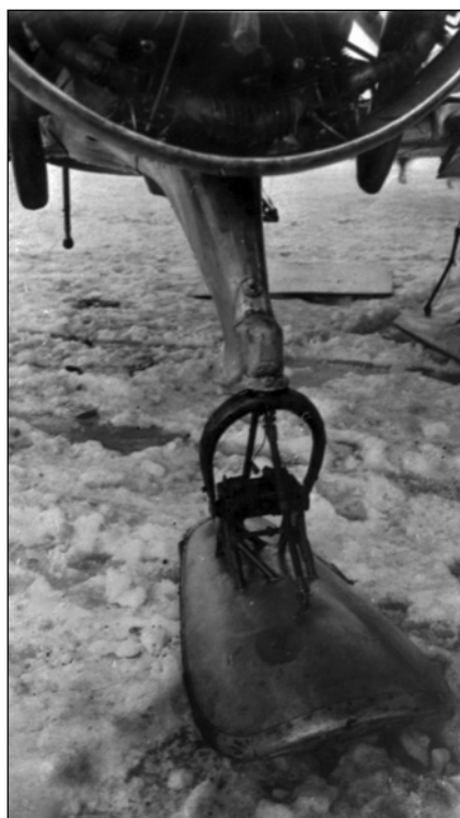
Передняя стойка шасси А-7 с установленной лыжей
