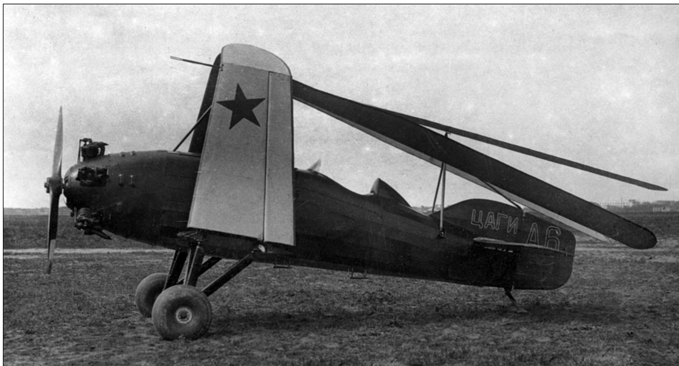
Демонстрация автожира ЦАГИ А-6 со сложенными крыльями и лопастями ротора на Центральном аэродроме 8 июня 1933 г. Хорошо заметна специальная ферма для фиксации ротора в сложенном положении (фото вверху и на с. 26)
