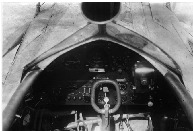
Вид на приборную доску пилота А7бис. В верхней части снимка зеркало заднего обзора
