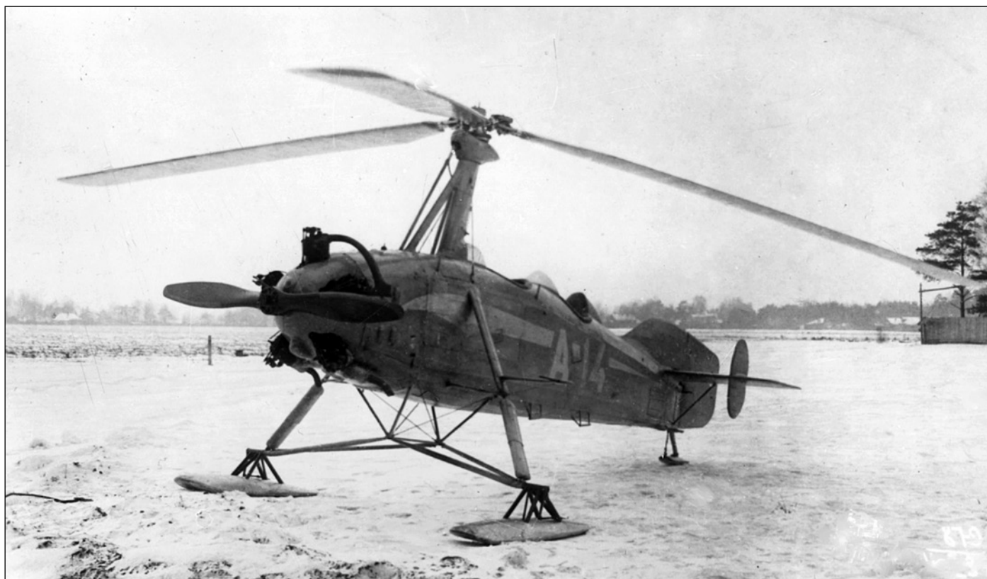
Автожир А-14 в процессе испытаний на лыжном шасси на аэродроме Ухтомка под Москвой. 16 января 1937 г.
