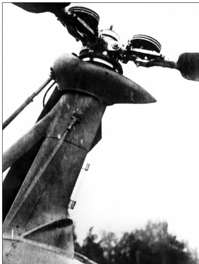
Узел крепления ротора автожира А-8
