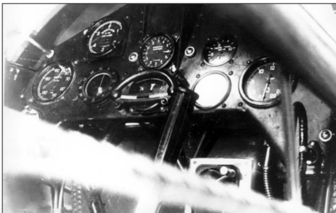
Приборная доска передней кабины пилота автожира А-13
